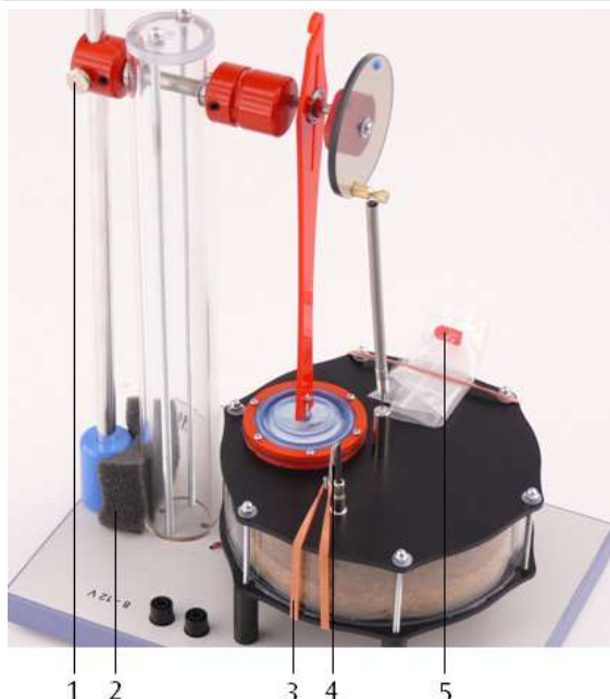
Fig. 7: Motore Stirling in condizioni di sicurezza
