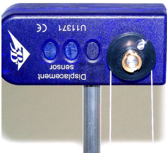
Fig. 3 : Guidage du fil autour de la poulie
