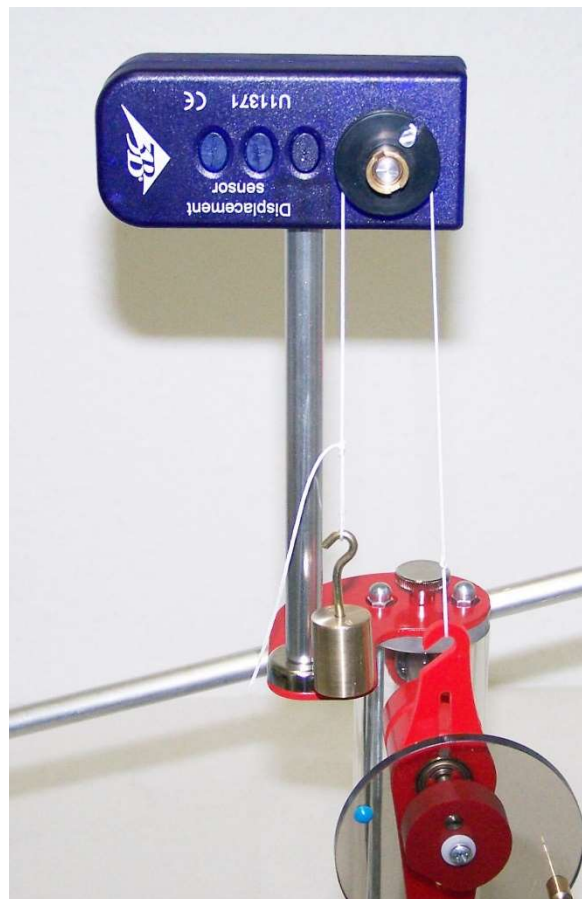
Fig. 5: Fixação do fio no entalho do excêntrico
