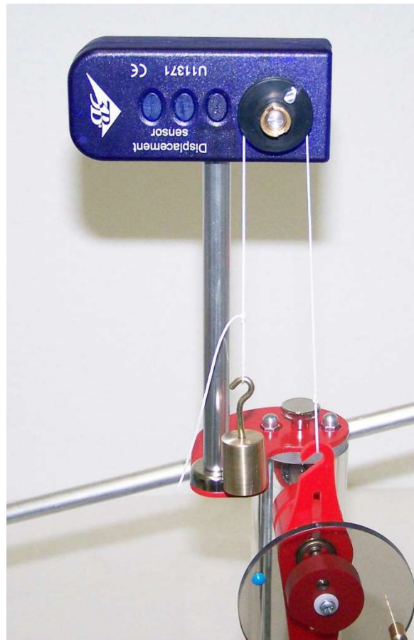
Fig. 5: Befestigung des Fadens am Pleuelhaken
