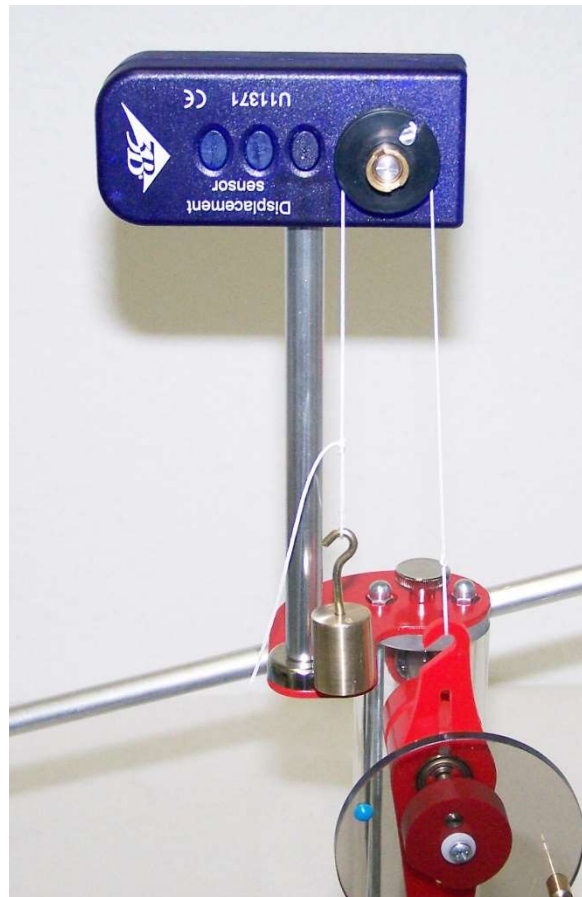
Fig. 5: Fijación del hilo en el gancho de la biela
