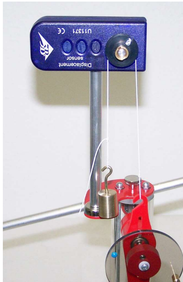
Fig. 5: Fissaggio del filo al gancio della biella
