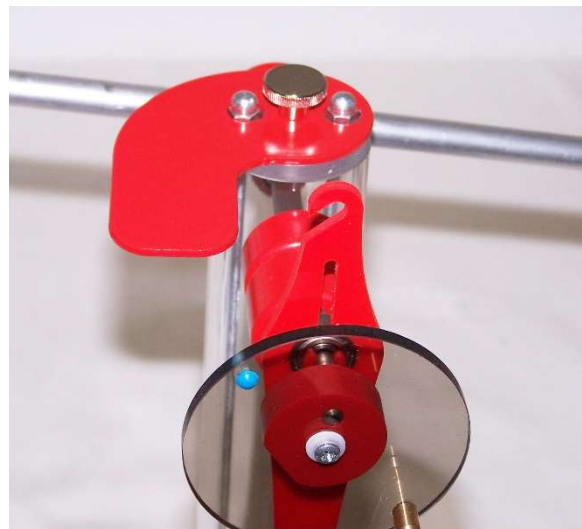
Fig. 1: Montaggio della piastra di supporto
