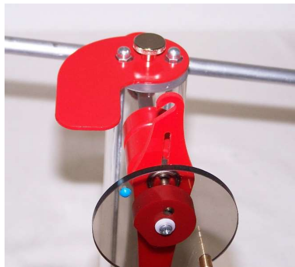
Fig. 1: Montagem da placa de suporte
