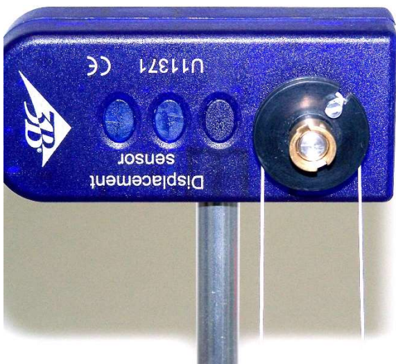
Fig. 3: Fadenführung um die Rolle
