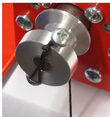
Fig. 1 Fixação do fio
