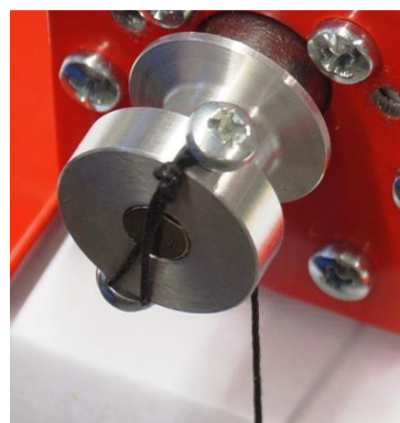
Fig. 1 Fixation du câble
