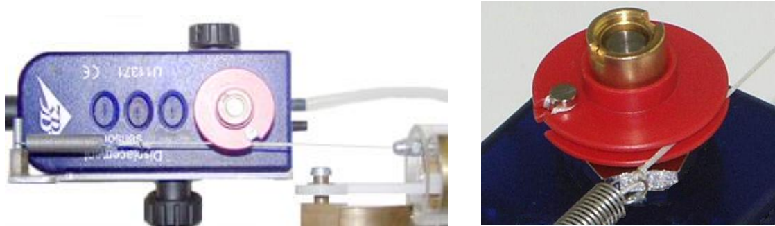
Fig. 2 Montaje del hilo en la roldana de cuerda del captador de camino
